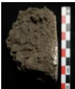
Figura 3.11. Estratigrafía: Argamasa compacta de granulometría fina. Enlucido de grosor delgado. Fragmento de excavación
