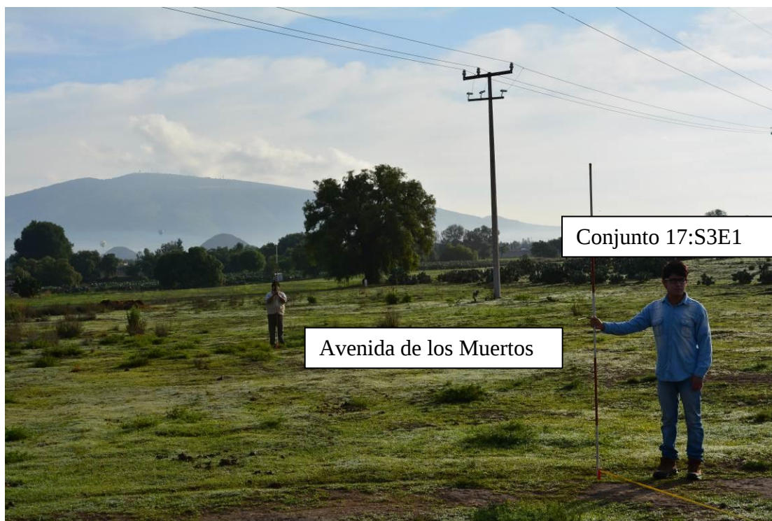
Figura 3.3. Establecimiento del eje central en la Avenida de los Muertos, representando el punto 0 de la retícula de excavación.
