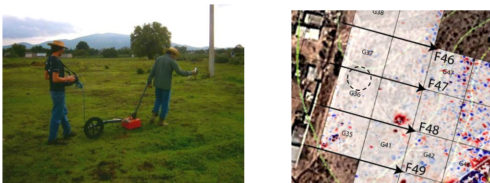
Figura 2.23. Verificaciones con georradar para localizar el límite oriental de la Avenida de los Muertos.
